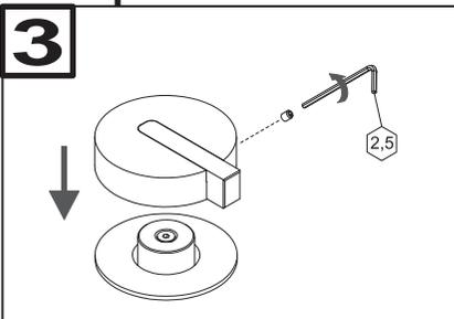
**IT** Rimontare il comando mantenendo la leva rivolta verso destra come in figura.
