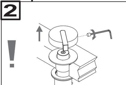
**IT** Sfilare il comando senza ruotarlo ulteriormente.
