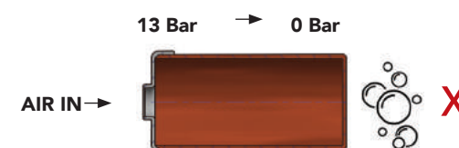
Test di tenuta ad immersione in acqua Water submergence test
